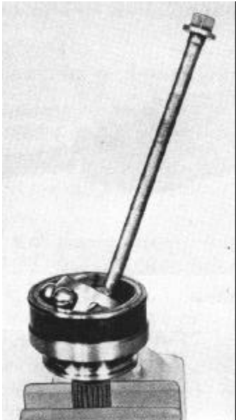
Bild F 21. Demontage des Gelenkes
