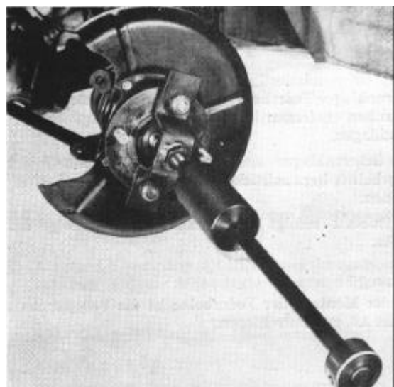
Bild F 11. Radmitnehmer mit dem Spezialwerkzeug "Konterschlaggerät" herausziehen
