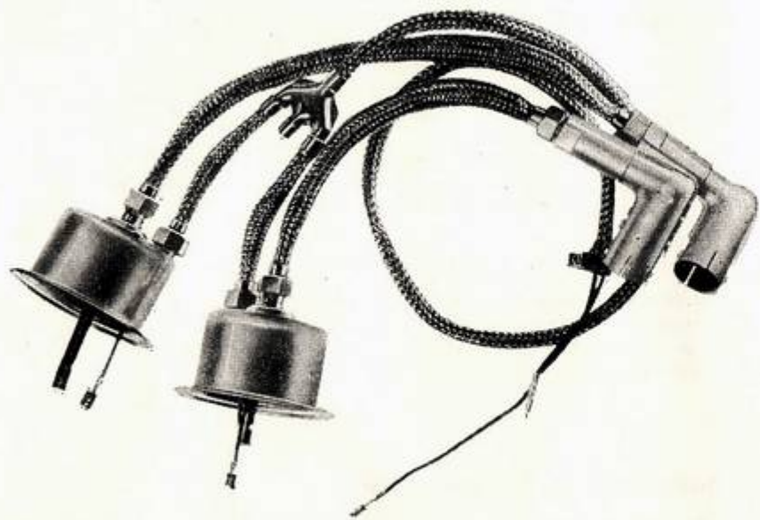
Bild 1 Montage des Entstörgeschirrs
